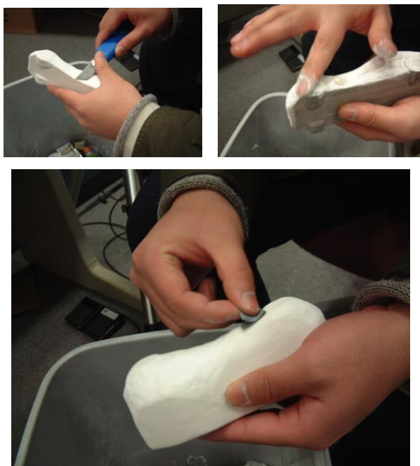
図5 物理モデルの手作業による修正
