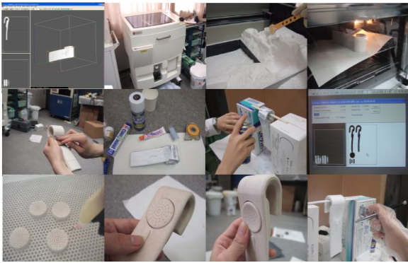
Fig.4 RPでのモデル造形と後処理
