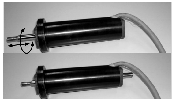
図2: 試作した二自由度モータの外観
