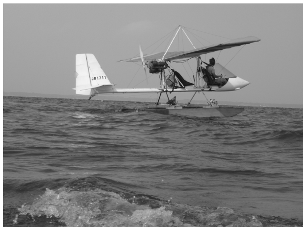
写真5 高速滑走試験時の波の状態
