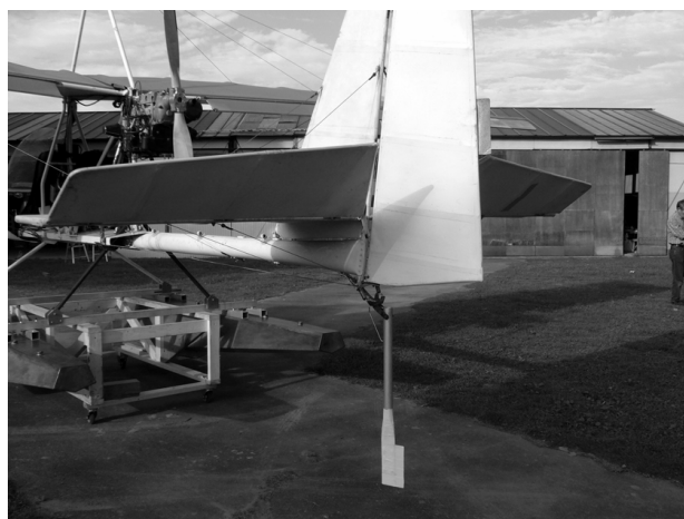
写真3 尾翼に装着した水中ラダー
