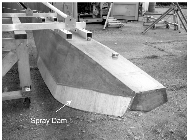
写真2 左フロートに装着したスプレーダム
