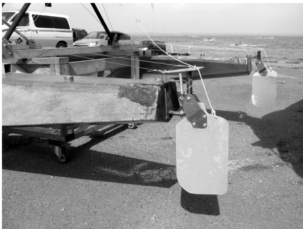
写真4 フロートに追加装着した水中ラダー
