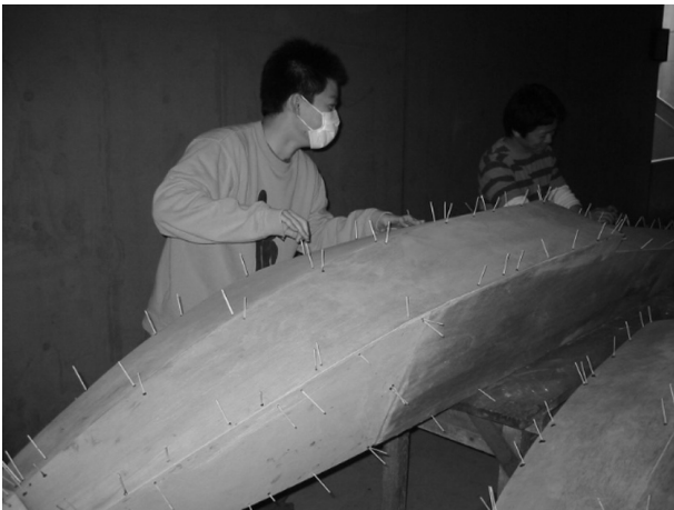
図8 外板を仮止めした細釘穴の処理
