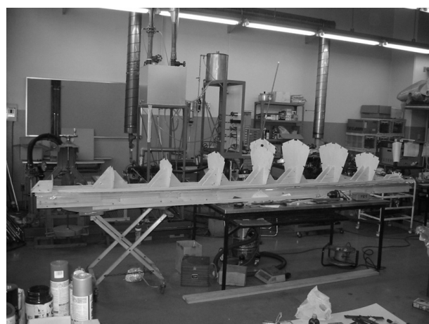
図 2 組み立て台と位置決め用の直角三角板を用いて所定の位置に配置した隔壁
