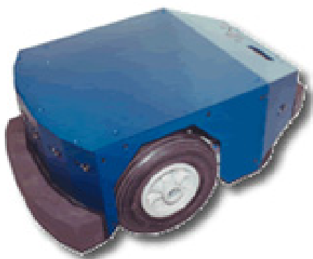
図 3: 中型実験用知的ロボットプラットフォーム LABO-3 (3)
