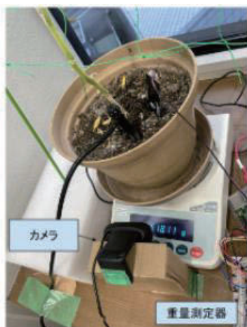
図5 重量部の外観
