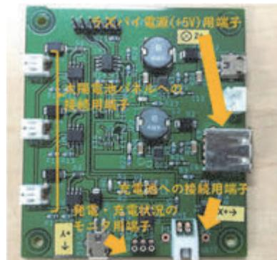
図 8 太陽電池パネル用の電源基板
