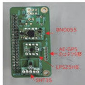
図4 環境計測部とセンサ用基板の外観
