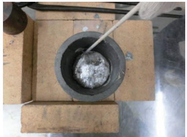
図5 溶湯中の酸化膜、および、酸化物
