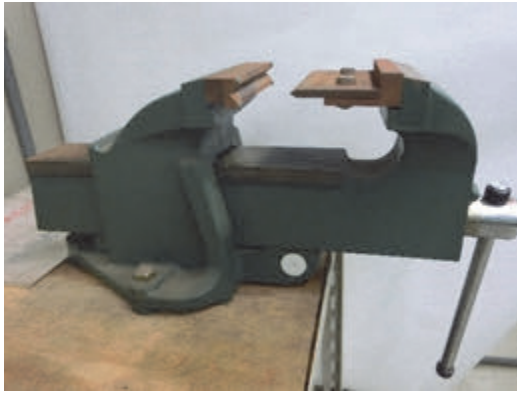
図5 パイス転用型のV字曲げ加工機
