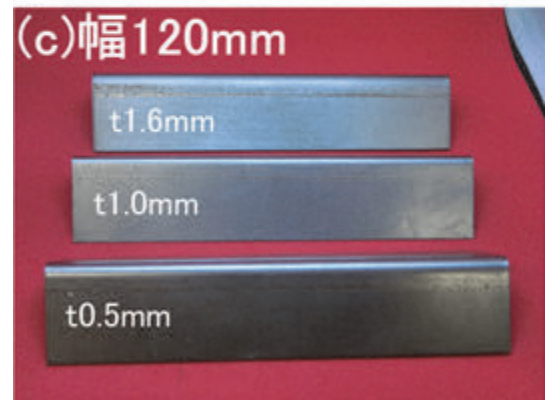
図8 V字曲げ試料側面 (a) 試料幅 30mm, 左 t0.5mm, 中央 t1.0mm, 右 t1.6mm, (b) 試料幅 60mm, 左 t0.5mm, 中央 t1.0mm, 右 t1.6mm, (c) 試料幅 120mm, 前 t0.5mm, 中央 t1.0mm, 後 t1.6mm
