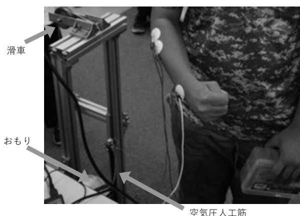
図 9. おもり吊り上げ実験の様子
