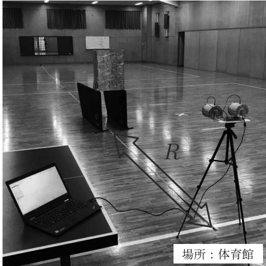
図 5: FMCW レーダを用いた距離 R の測定実験の様子
