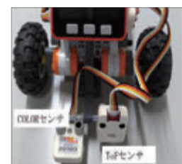
(4)センサ類をLEGOカーに接続する
