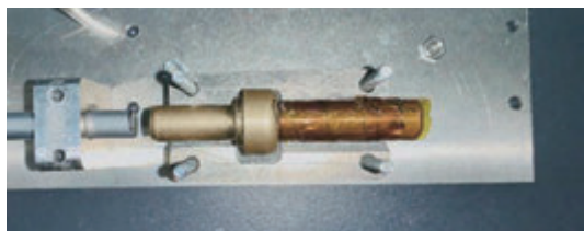
図 6 パラフィンアクチュエータとカプトンテープで固定されたニクロム線 日本サーモスタット(株)
