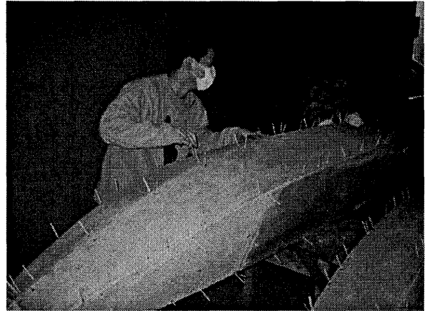
図： 外板を仮止めした細釘穴の処理
