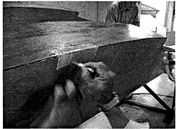
図： 外板合わせ部のHTR補強
