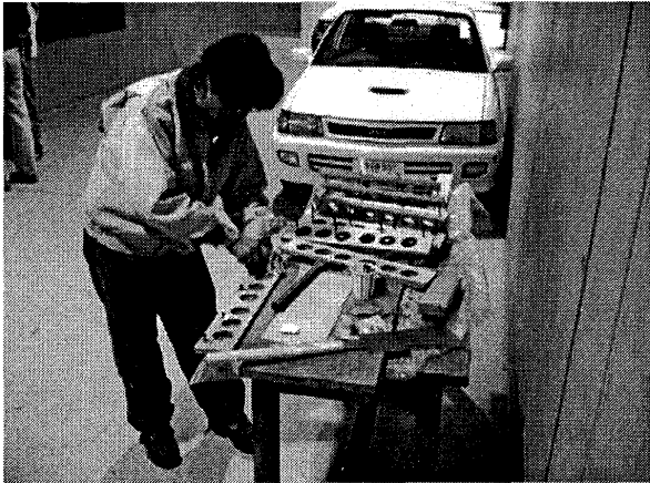
図8 フロート支持部のための内部補強板の製作。スプレッダーとの締結ボルトはこの補強板に裏側から圧入接着した。
