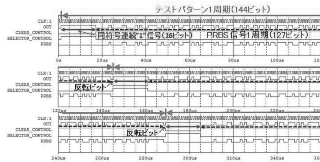
図7. 16ビットの同符号連続“1”信号を含むテストパターン生成の論理シミュレーションによる確認
