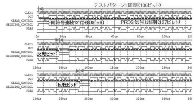
図8. 8ビットの同符号連続“0”信号を含むテストパターン生成の論理シミュレーションによる確認
