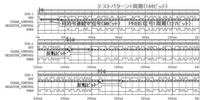
図9. 16ビットの同符号連続“0”信号を含むテストパターン生成の論理シミュレーションによる確認
