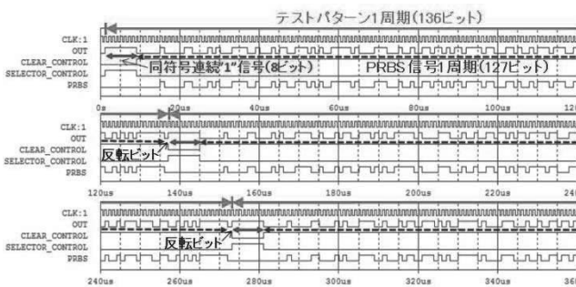
図6. 8ビットの同符号連続“1”信号を含むテストパターン生成の論理シミュレーションによる確認
