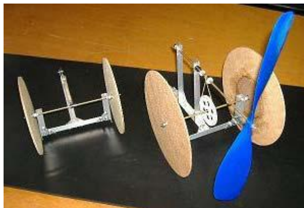
図3 輪ゴム動力ビークル(左)・風力ビークル(右)
