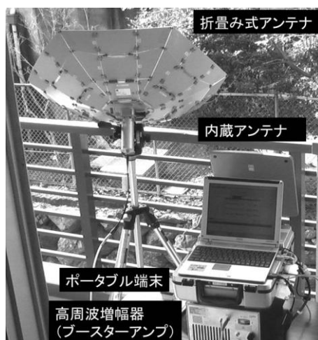
図2 ETS-VIIIのための地球局システム(内蔵アンテナ、折畳式アンテナ使用時の一例)
