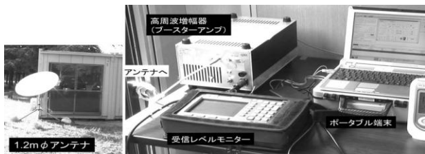
図3 ETS-VIIIのための地球局システム (JAXA 折り返し実験の様子)
