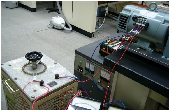
図6. 可変抵抗に接続したDC発電機
